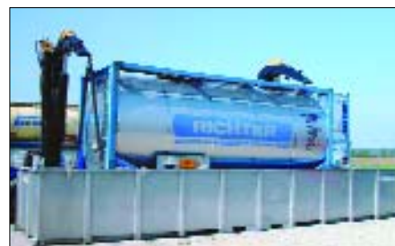
Ergänzend zu TUIS halten Fachlogistiker Spezialequipment wie mobile Notfallwanne zur Bergung von Containern vor – hier bei Curt Richter in Mehring-Öd.
