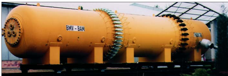
Versuchstank THEBETA zur Untersuchung der Wirkung von Explosionsdruckstößen
